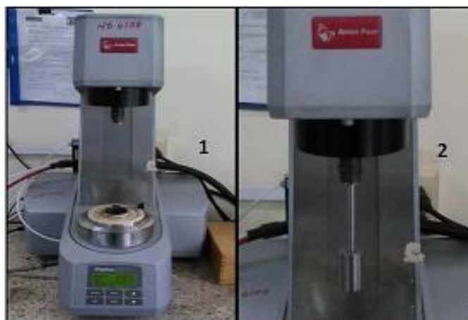
Figura 4. Reómetro Anton Paar Physica MCR 301 utilizado en la experimentación (1- Vista general, 2- Vista del sensor).
