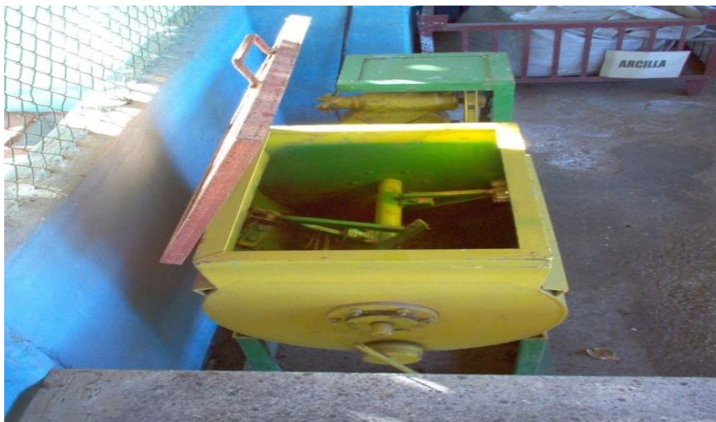
Fig. 2 Mezclador empleado en el proceso de fabricación del tradifiltro.
