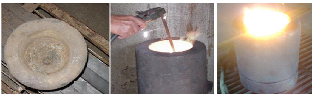
Figura 1. Reactor de grafito utilizado para el procesamiento aluminotérmico.
