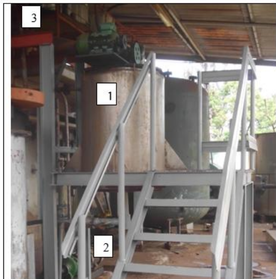
Fig. 1. Reactor con mecanismo de agitación y camisa de calentamiento (1), bomba centrífuga, (2) y recipiente para suministro de hidróxido de sodio, (3).
