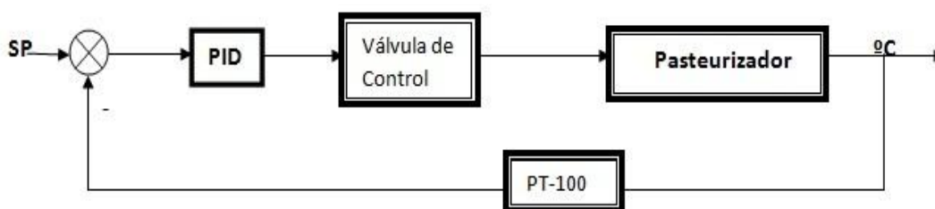
Figura 8. Diagrama de bloques del lazo de control.
