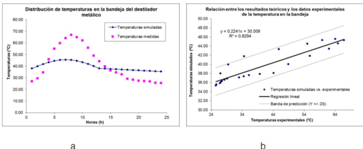
**Fig. 7-** Temperaturas en la bandeja del destilador metálico. a) Valores experimentales comparados con los simulados. b) Relación entre los valores experimentales y los simulados.
