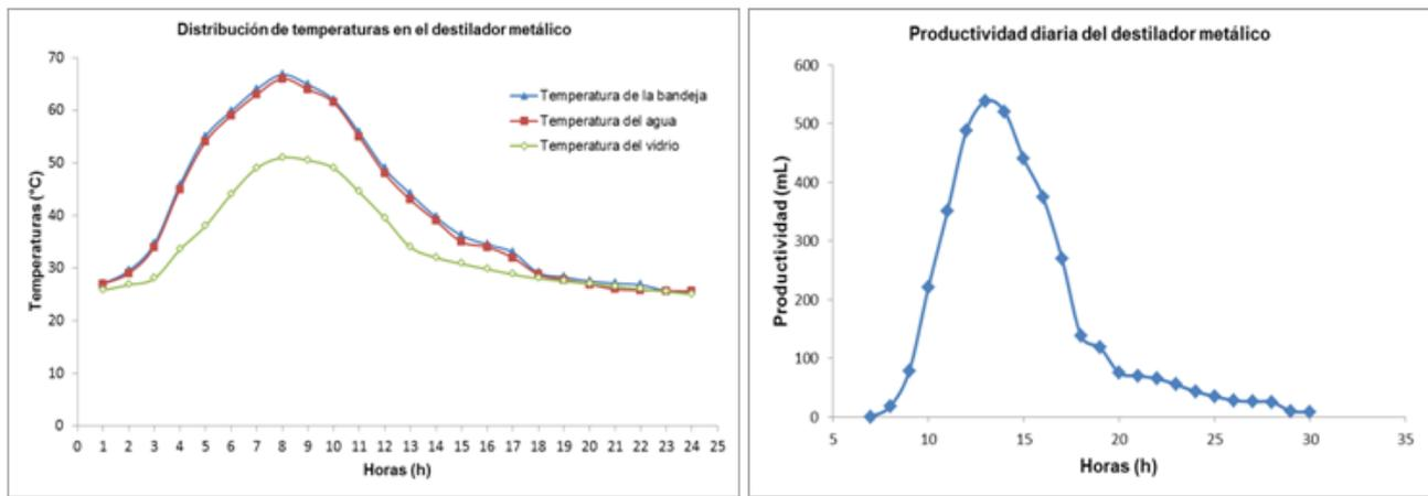
**Fig. 2-** a) Distribución de temperaturas y b) Productividad diaria del destilador metálico.
