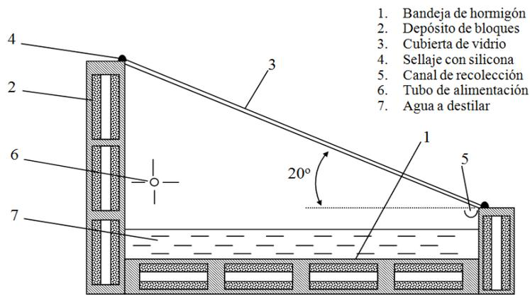
**Fig. 3-** Esquema del destilador de materiales de la construcción utilizado en las mediciones experimentales.
