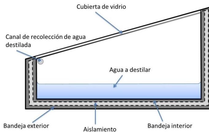
**Fig. 5-** Esquema del destilador de fibra de vidrio utilizado en las mediciones experimentales.
