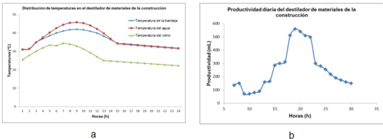
**Fig. 4-** a) Distribución de temperaturas y b) Productividad diaria del destilador de materiales de la construcción.
