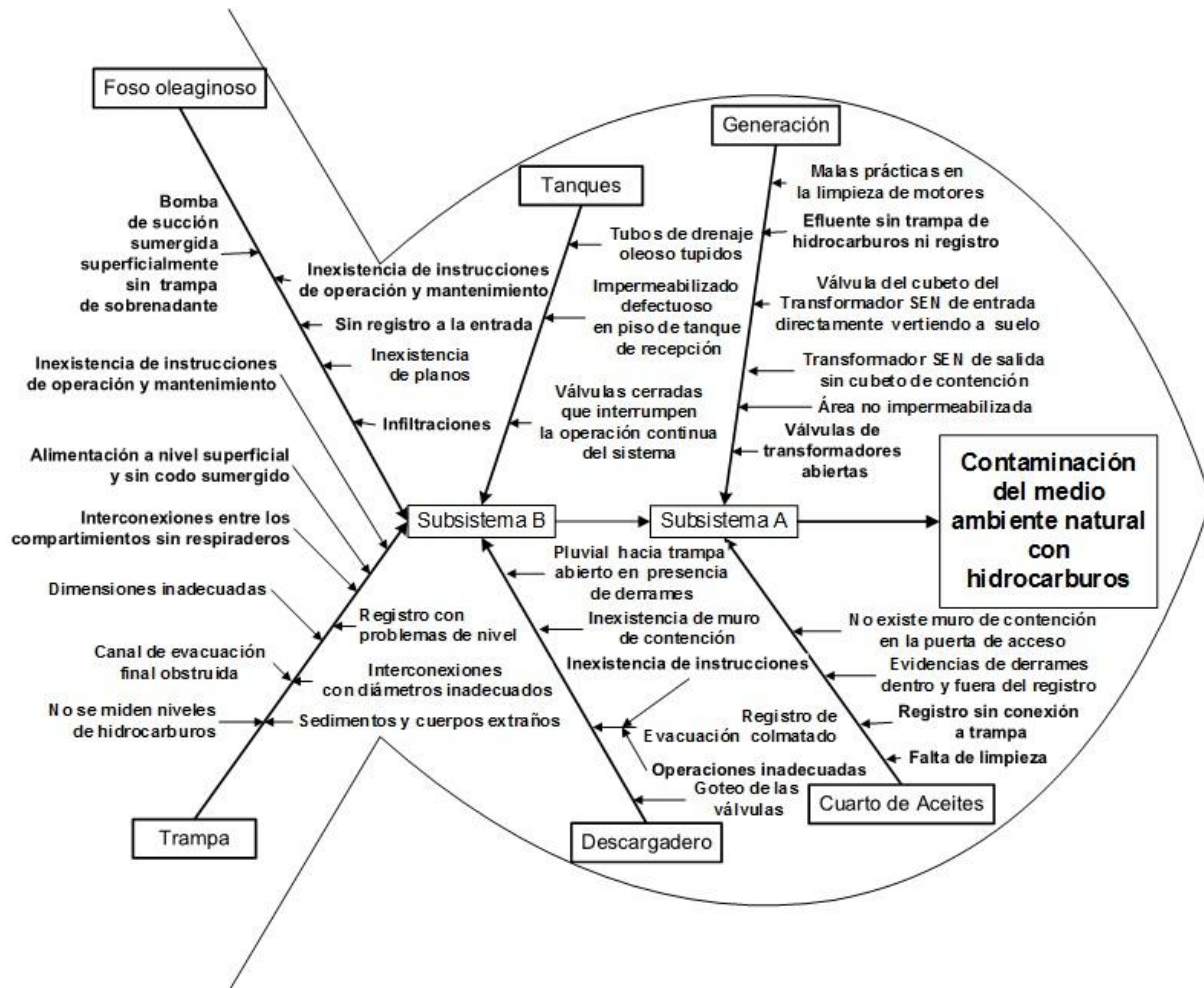
Fig. 4- Diagrama causa-efecto para la contaminación por hidrocarburos del sistema del grupo electrógeno de diésel de Cruces.
