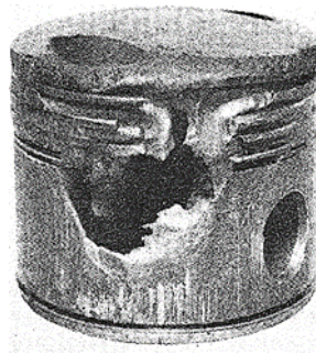
Fig.2- Efecto de la detonación en émbolo de MCI de gasolina
