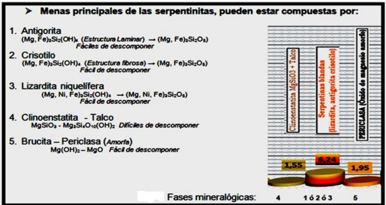
**Fig. 2-** Algunas fases mineralógicas de las menas serpentiniticas identificadas en forma de gráficos de barras
