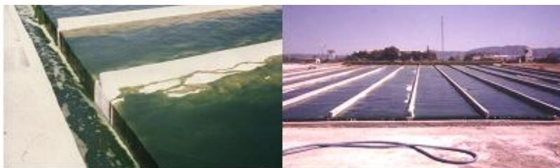
**Fig.1-** Fotobiorreactor de capa fina de 500 m<sup>2</sup>. Centro de Investigaciones de Energía Solar. Santiago de Cuba
