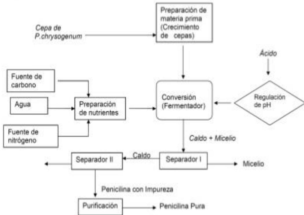
**Fig. 4-** Diagrama de flujo de producción de penicilina presentado por los estudiantes.
