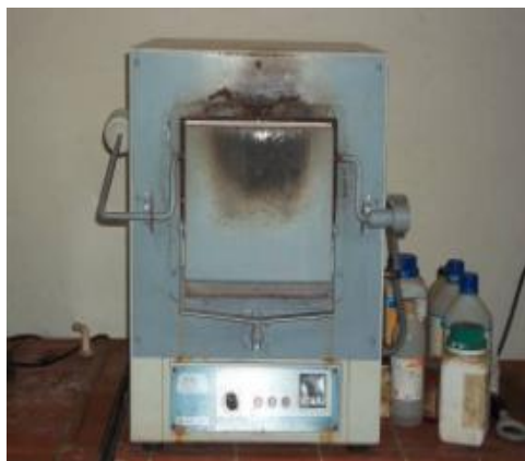
Fig. 2- Horno eléctrico J.P Selecta 2000
