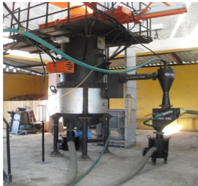
Fig. 3- Gasificador downdraft. Modelo COMBO-80
