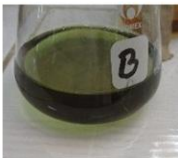
Fig. 4. Punto final de la titulación del tiosulfato de sodio para 0.1 N con almidón ( C_6H_{10}O_5 ) n como indicador.
