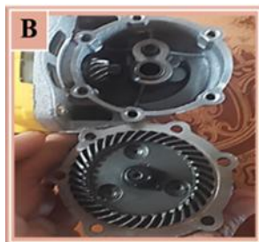
Fig. 5- Partes internas del equipo después de la remoción de la grasa trabajada
