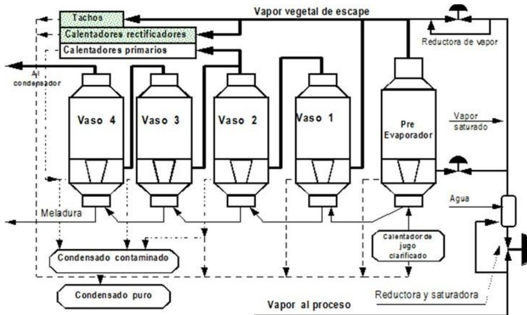
**Fig. 1-** Esquema típico de uso del vapor en una estación de evaporación de ingenios azucareros <sup>(11)</sup>
