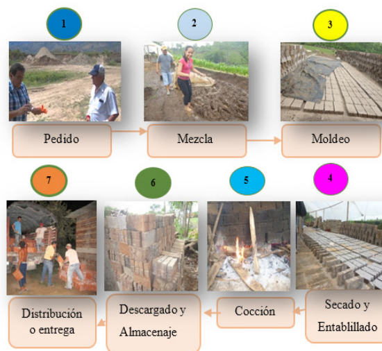
Figura 4. Proceso en la elaboración del ladrillo en la Mipyme La Mano Amiga.
