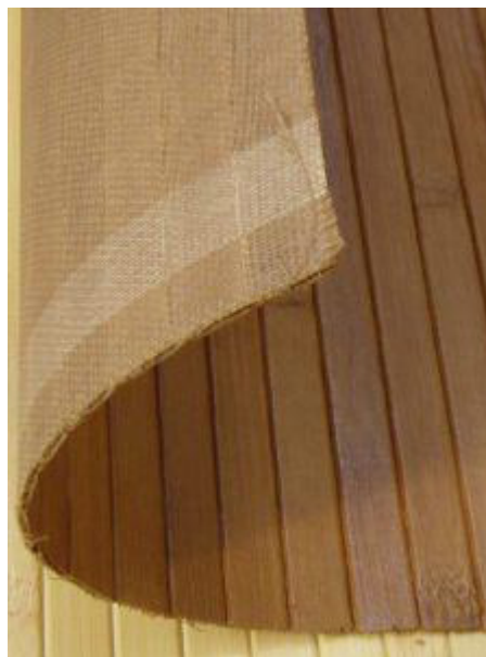
Figura 2 Panel de fibra de caña guadúa
