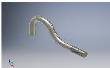
Figura 11. Gancho para la celda de carga
