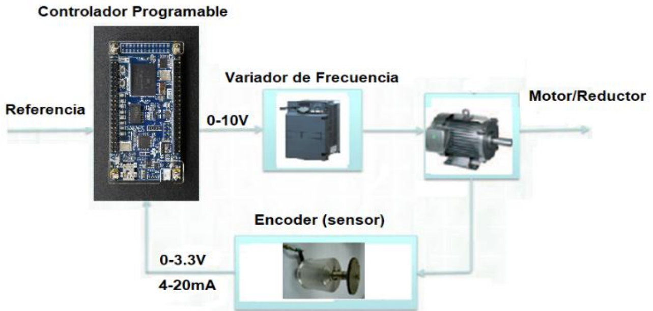
Figura 1. Diagrama de bloques para el control de velocidad de un motor de inducción trifásico.
