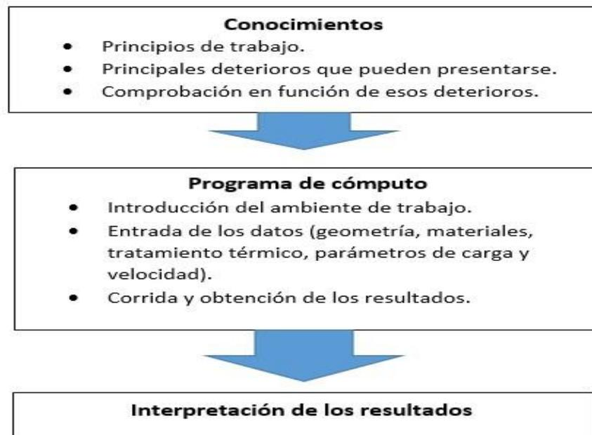
**Fig. 5:** Secuencia de trabajo para el método automatizado.
