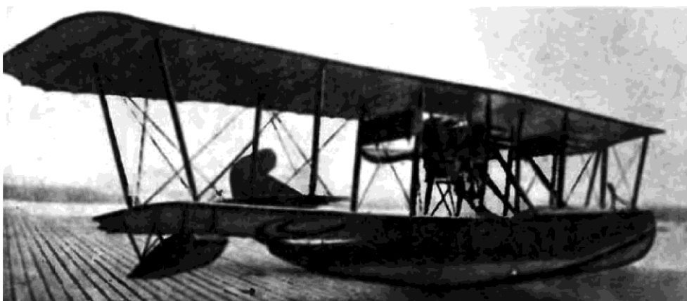
Figura 3. Hidroavión del tipo M-9. Una versión mejorada del M-5 sobre la base de un motor más potente (150 c/f) y que alcanzaba velocidades de 110 km/h.
